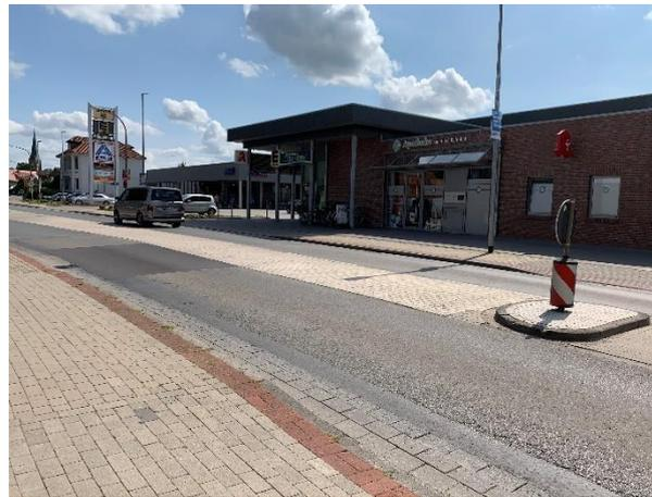
Abbildung 26: Mangelhafte Querungsmöglichkeit Quakenbrücker Straße
